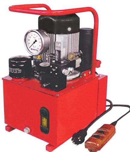
В качестве рабочей жидкости рекомендуется использовать следующие марки масел: ВМГ3 ТУ 38 101479-86, МГЕ-10А ОСТ 38 01281-82, а также другие марки масел с вязкостью 13,5–16,5 сСт при температуре +40°C, очищенное до 13-го класса чистоты по ГОСТ 172116-71.
