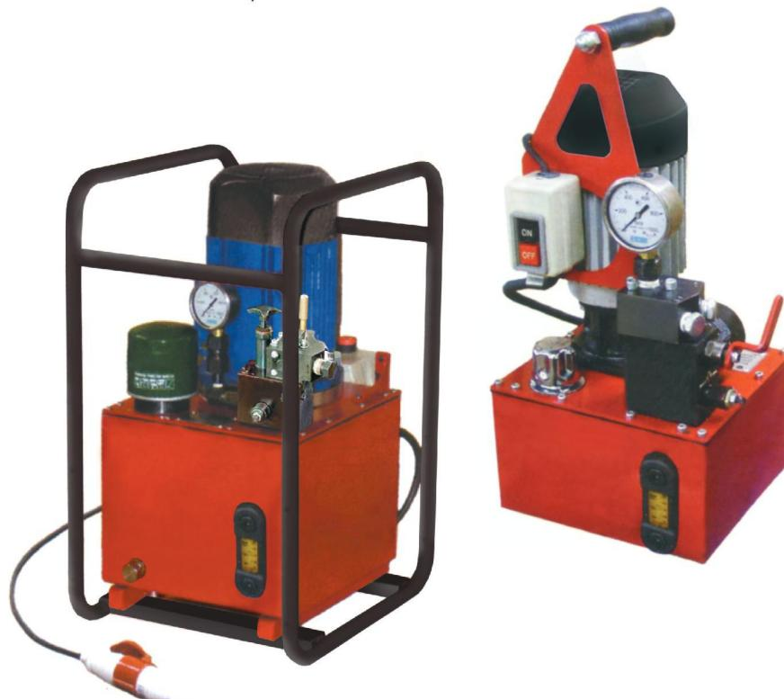
В качестве рабочей жидкости рекомендуется использовать следующие марки масел: ВМГ3 ТУ 38 101479-86, МГЕ-10А ОСТ 38 01281-82, а также другие марки масел с вязкостью 13,5–16,5 сСт при температуре +40°C, очищенное до 13-го класса чистоты по ГОСТ 172116-71.
